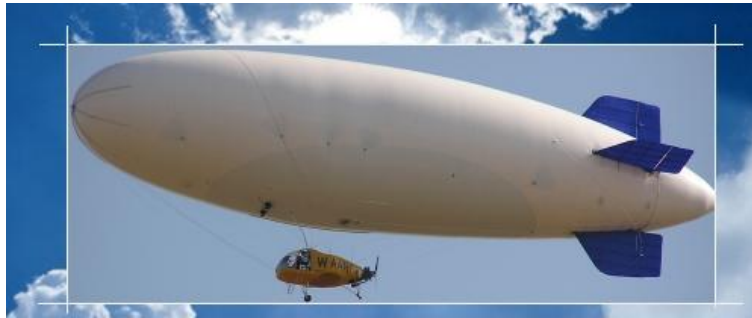
Figure 1: Le Voliris 900. Dirigeable non rigide ayant servi comme modèle pour notre étude.
