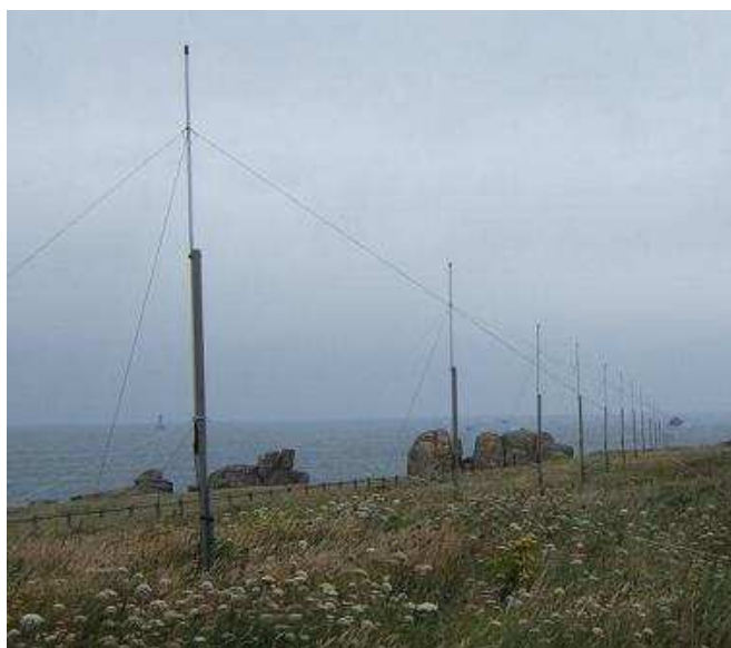
Figure 1: Un réseau de réception côtier d'un radar HFSWR.
